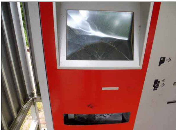
Abbildung 23: Bildschirm und Ausgabefach des Fahrkartenautomaten in Katharinenheerd wurden gewaltsam stark beschädigt.
