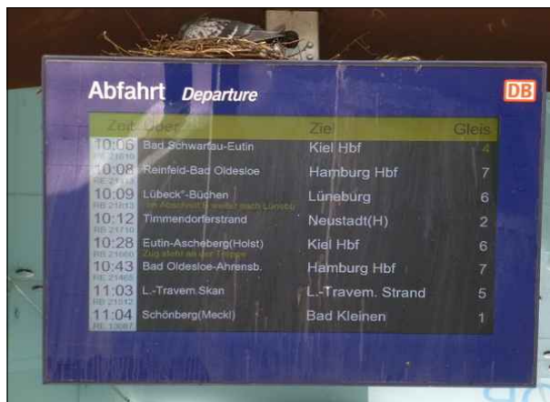
Abbildung 16: Durch ein Taubennest auf dem Abfahrtsmonitor im Gang vom ZOB zum Hauptbahnhof in Lübeck ist dieser fast immer verschmutzt.
