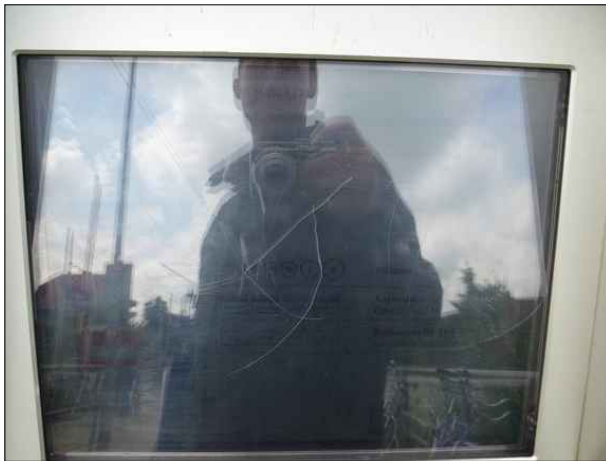
Abbildung 40: Nur sehr schwer war die Anzeige im Bildschirm des Fahrkartenautomaten in Herzhorn zu erkennen.
